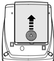
2. Coloque 4 pilas "AA" de modo que las polaridades positiva (+) y negativa (-) coincidan con las del compartimiento.
