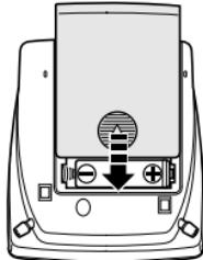
**NOTA:** Si el indicador de pilas descargadas aparece en el visor, recambie las cuatro pilas.
